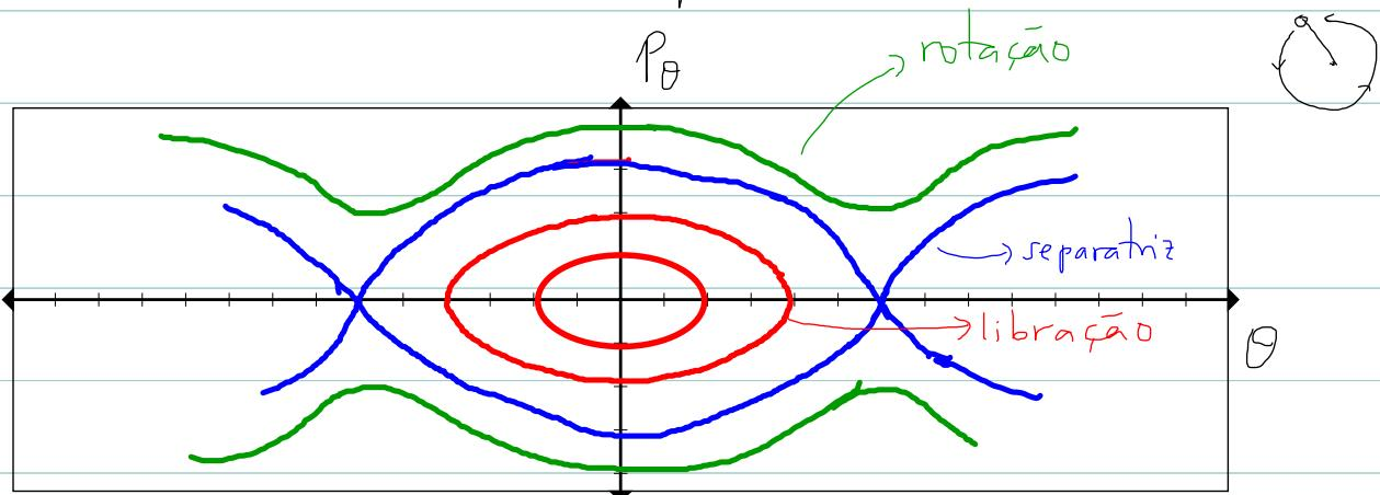
Há é claro uma interface entre os dois tipos, quando  $E = mgl$ , chamada linha separatrix. Corresponde ao caso em que o movimento tende a parar exatamente com o pêndulo virado de cabeça para baixo. Vale observar que, como a curva ( $P_0=0, \theta=\pi$ ) é uma solução, e soluções não se cruzam no espaço de fase, então o movimento de um pêndulo lançado de  $\theta \neq \pi$  com  $E = mgl$  aprofunda, mas nunca chega a alcançar, esse ponto.
